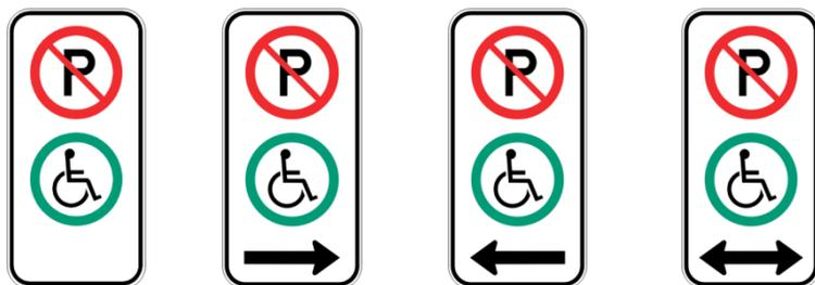
L'emplacement de ces panneaux est réglementé selon la norme édictée par le MTQ. La figure suivante montre la façon adéquate de signaler les espaces de stationnement réservés aux personnes handicapées à l'aide des différents modèles de panneaux P 150-5.
