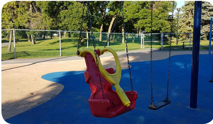
Balanoire adaptée, située sur un plancher de caoutchouc, visant à faciliter les déplacements des personnes circulant à l'aide d'un fauteuil roulant
